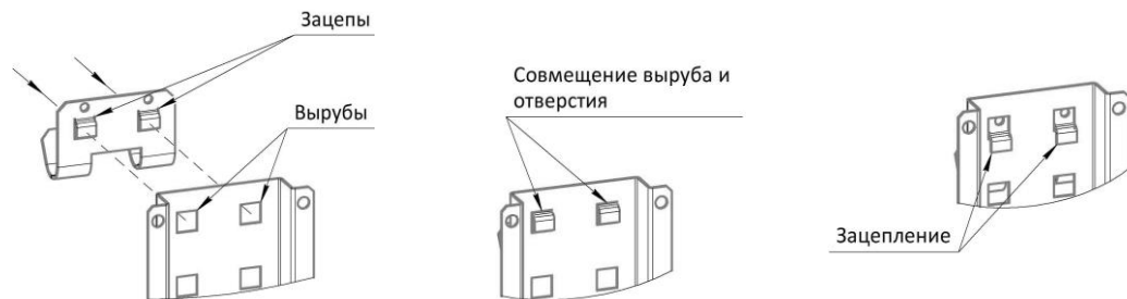
Рисунок 4 - Установка навесных элементов.
